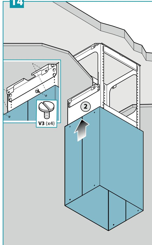
IT - Installazione camera motore (15); collegamento elettrico e fissaggio camino + prolunga (16).
